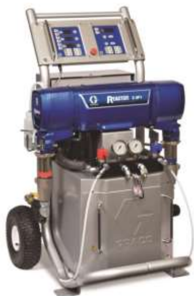
Дозаторная установка Reactor E-XP1, пистолет Probler P2, шланг с подогревом с защитной оплеткой, 10 кВт, 400 В, 3 фазы
