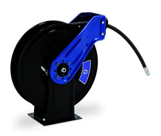
XDX™ 10, масло, впускное отверстие 13 мм (1/2"), шланг 13 мм X 11 м (1/2" X 35 футов), NPT, подвесное крепление, синий металлик
