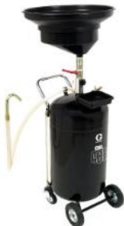
Система перекачивания масла с 90-литровым (24 галл.) стальным резервуаром, всасывающими зондами, смотровыми окнами, сливной трубкой
