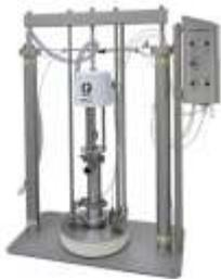
**Агрегат SaniForce 5:1, насос из углеродистой стали с прайминг-поршнем для разгрузки бочек**
