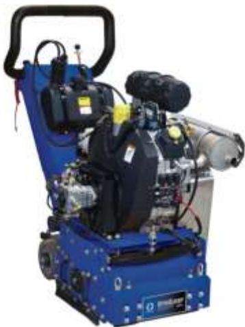
GrindLazer HP DC1520 E DCS – самоходная электрическая демаркировочная машина, комплект шкивов со стандартной скоростью
