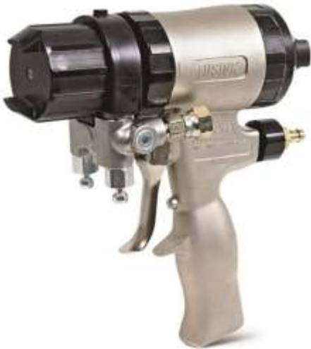
Распылитель Fusion с функцией механической очистки с круглым факелом и размером отверстия 1,8 мм (0,070") и смесительной камерой
