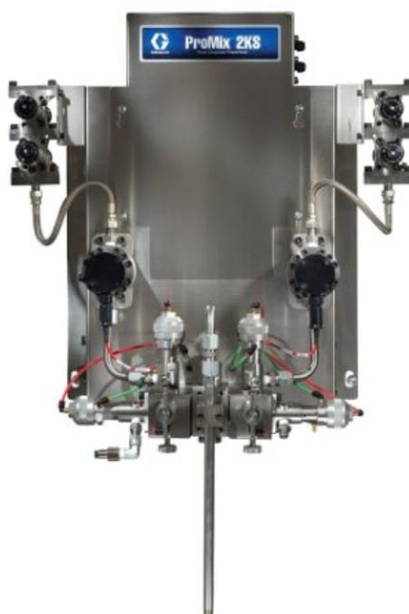
**Автоматическая настенная система ProMix 2KS, EasyKey, кориолисов расходомер 1/8 дюйма (А) и G3000HR (В), 12 клапанов подачи матери...**
