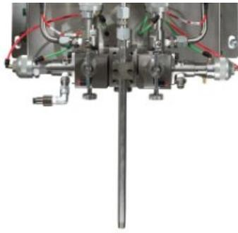
**Автоматическая настенная система ProMix 2KS, EasyKey, кориолисов расходомер 1/8 дюйма (А) и G3000HR (В), четыре клапана подачи мат...**
