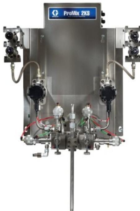
**Ручная настенная система ProMix 2KS, EasyKey с ЖК-дисплеем, расходомеры G3000HR (А) и (В), семь клапанов подачи материала низкого ...**
