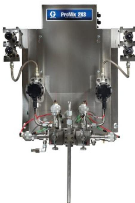
**Автоматическая настенная система ProMix 2KS, EasyKey, кориолисовы расходомеры 1/8 дюйма (А, В), два клапана подачи материала**
