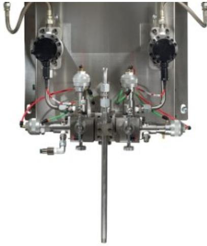
**Ручная настенная система ProMix 2KS, EasyKey с ЖК-дисплеем, расходомеры G3000HR (А) и (В), семь клапанов подачи материала низкого ...**
