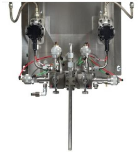
**Автоматическая настенная система ProMix 2KS, EasyKey с ЖК-дисплеем, расходомер G3000HR, семь клапанов подачи материала и один ката...**
