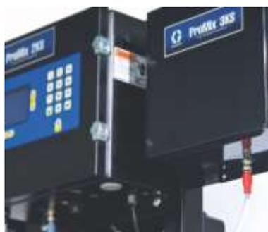
**Дозатор ProMix 3KS, кориолисов расходомер 1/4 дюйма, два клапана подачи материала низкого давления**
