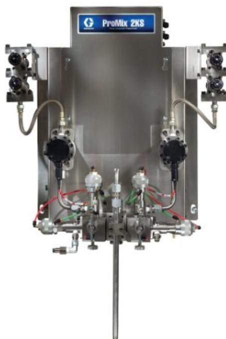
**Автоматическая настенная система ProMix 2KS, EasyKey с ЖК-дисплеем, расходомер G3000HR, один цвет и один катализатор**
