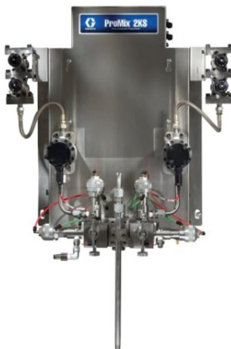
**Ручная настенная система ProMix 2KS, EasyKey с ЖК-дисплеем, расходомеры G3000 (А) и (В), четыре клапана подачи материала высокого ...**
