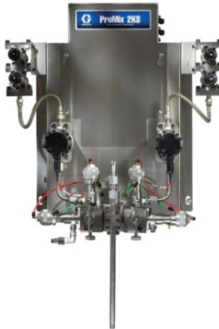
**Автоматическая настенная система ProMix 2KS, EasyKey с ЖК-дисплеем, расходомер G3000HR, семь клапанов подачи материала и два клапа...**
