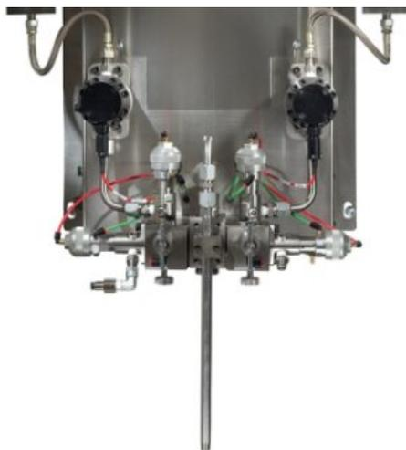
**Ручная настенная система ProMix 2KS, EasyKey с ЖК-дисплеем, 12 клапанов подачи материала низкого давления, четыре клапана дозирова...**
