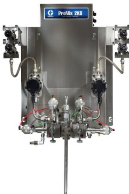
**Ручная настенная система ProMix 2KS, EasyKey с ЖК-дисплеем, расходомеры G3000 (А и В), два клапана подачи материала высокого давле...**
