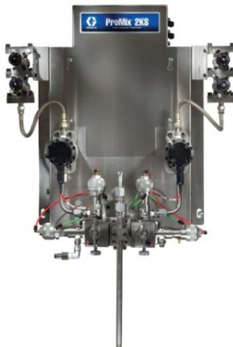
**Автоматическая настенная система ProMix 2KS, EasyKey, расходомеры G3000 (A) и кориолисов 1/8 дюйма (B), 12 клапанов подачи материа...**
