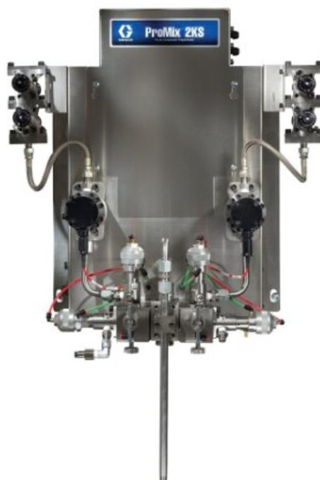
**Ручная настенная система ProMix 2KS, EasyKey с ЖК-дисплеем, семь клапанов подачи материала низкого давления, четыре клапана дозиро...**
