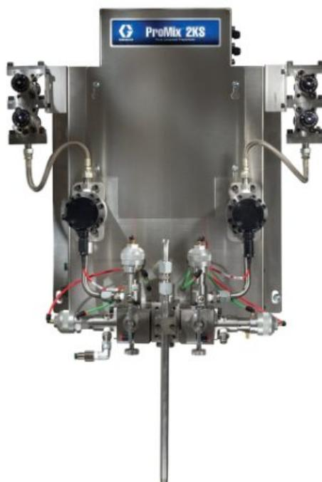
**Автоматическая настенная система ProMix 2KS, EasyKey, кориолисов расходомер 1/8 дюйма (А, В), два клапана подачи материала, два кл...**
