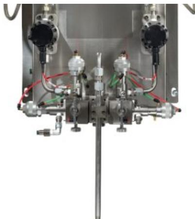
**Автоматическая настенная система ProMix 2KS, EasyKey, кориолисовы расходомеры 1/8 дюйма (А, В), четыре клапана подачи материала, о...**
