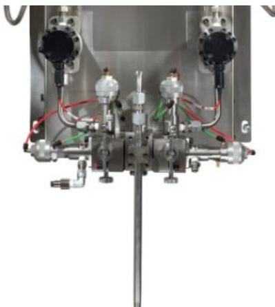
**Ручная настенная система ProMix 2KS, EasyKey с ЖК-дисплеем, расходомеры G3000 (А и В), 12 клапанов подачи материала низкого давлен...**
