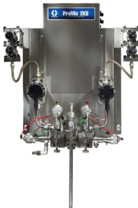
**Автоматическая настенная система ProMix 2KS, EasyKey, расходомеры G3000 (A) и кориолисов 1/8 дюйма (B), семь клапанов подачи матер...**
