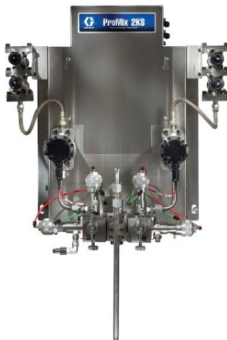
**Ручная настенная система ProMix 2KS, EasyKey с ЖК-дисплеем, расходомеры G3000HR (А) и (В), 12 клапанов подачи материала низкого да...**
