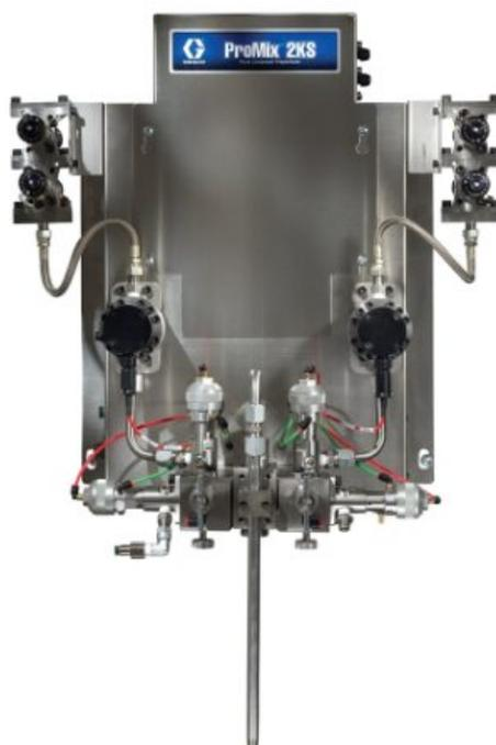
**Ручная настенная система ProMix 2KS, EasyKey с ЖК-дисплеем, расходомеры G3000HR (А) и (В), два клапана подачи материала высокого д...**
