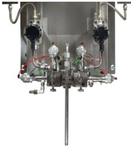
**Автоматическая настенная система ProMix 2KS, EasyKey, расходомеры G3000HR (A) и кориолисов 1/8 дюйма (B), два клапана подачи матер...**
