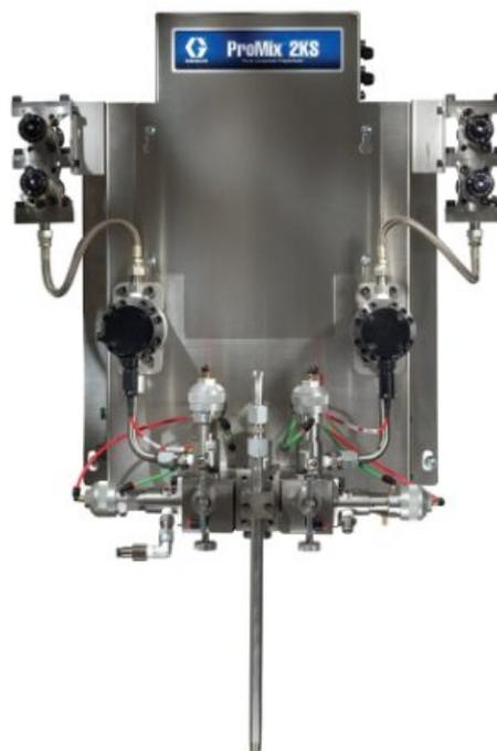
**Автоматическая настенная система ProMix 2KS, EasyKey, расходомеры G3000HR (А) и кориолисов 1/8 дюйма (В), 12 клапанов подачи матер...**
