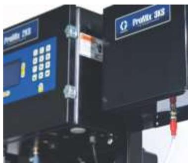
**Дозатор ProMix 3KS, кориолисов расходомер 1/4 дюйма, два клапана подачи материала высокого давления**
