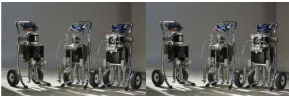
**Комплект безвоздушного механического дозатора 2:1 M2K, монтаж на тележке, краскораспылитель XTR и стандартный блок смешивания**
