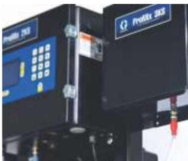
**Дозатор ProMix 3KS, расходомер S3000, четыре клапана подачи материала низкого давления**
