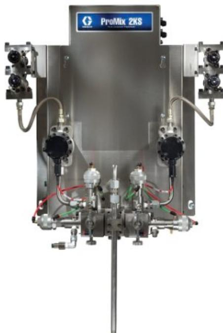
**Автоматическая настенная система ProMix 2KS, EasyKey с ЖК-дисплеем, расходомер G3000HR, два клапана подачи материала и два клапана...**
