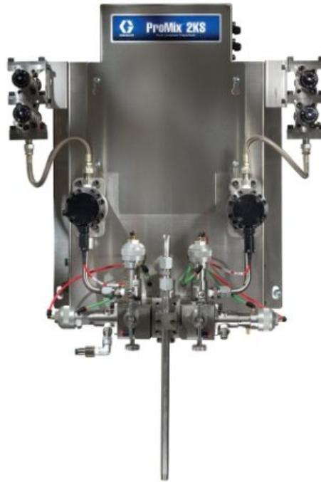
**Автоматическая настенная система ProMix 2KS, EasyKey, расходомеры G3000HR (A) и кориолисов 1/8 дюйма (B), два клапана подачи матер...**
