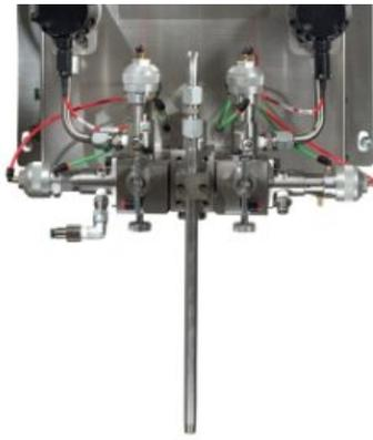
**Ручная настенная система ProMix 2KS, EasyKey с ЖК-дисплеем, семь клапанов подачи материала низкого давления, два клапана дозирован...**
