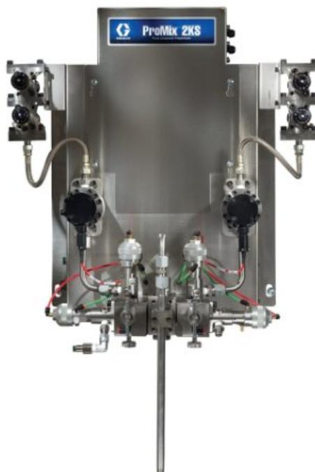
**Автоматическая настенная система ProMix 2KS, EasyKey, расходомеры G3000 (A) и кориолисов 1/8 дюйма (B), четыре клапана подачи мате...**
