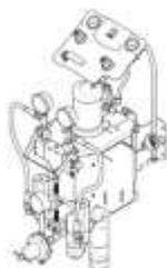
**Комбинированный механический дозатор 3:1 M2K, настенный монтаж, стандартный блок смешивания**
