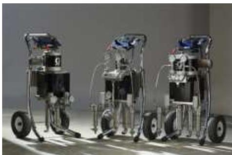
**Комплект безвоздушного механического дозатора 6:1 M2K, монтаж на тележке, краскораспылитель XTR и стандартный блок смешивания**
