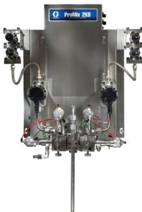
**Автоматическая настенная система ProMix 2KS, EasyKey, кориолисовы расходомеры 1/8 дюйма (A, B), четыре клапана подачи материала**
