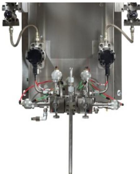
**Ручная настенная система ProMix 2KS, EasyKey с ЖК-дисплеем, семь клапанов подачи материала низкого давления, четыре клапана дозиро...**
