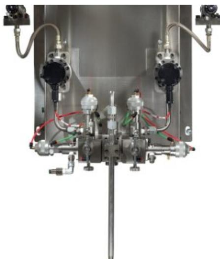
**Ручная настенная система ProMix 2KS, EasyKey с ЖК-дисплеем, расходомеры G3000 (А) и (В), четыре клапана подачи материала низкого д...**
