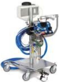
**Система нанесения гелкоута со смешиванием материала в головке с соотношением 13:1, 50 футов (15,2 м), шланг, тележка, стойка и ст...**
