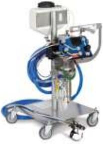
**Система нанесения гелкоута со смешиванием материала в головке с соотношением 13:1, 25 футов (7,6 м), шланг, тележка, мачта и стре...**
