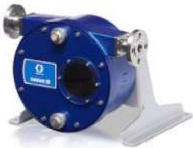
**SoloTech™ 23 — перистальтический шланговый насос из хайпалона, шланг из CSM, штуцер из нерж. стали 316, мотор BLDC**
