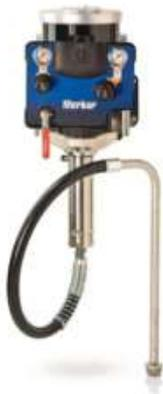
Комбинированная окрасочная установка Merkur 15:1, расход материала 1,5 л/мин (0,4 галл./мин), настенная, пистолет PerformAA 15, пн...
