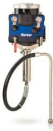
Насос Merkur 23:1, расход материала 6 л/мин (1,6 галл./мин), настенный, пневмоклапаны насоса, всасывающий шланг, фильтр ЛКМ, монит...
