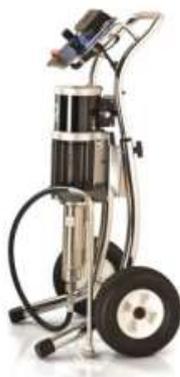
Насос Меркур 18:1, расход материала 7,5 л/мин (2 галл./мин), монтаж на тележке, краскораспылитель G40, пневмоклапаны насоса, всасы...
