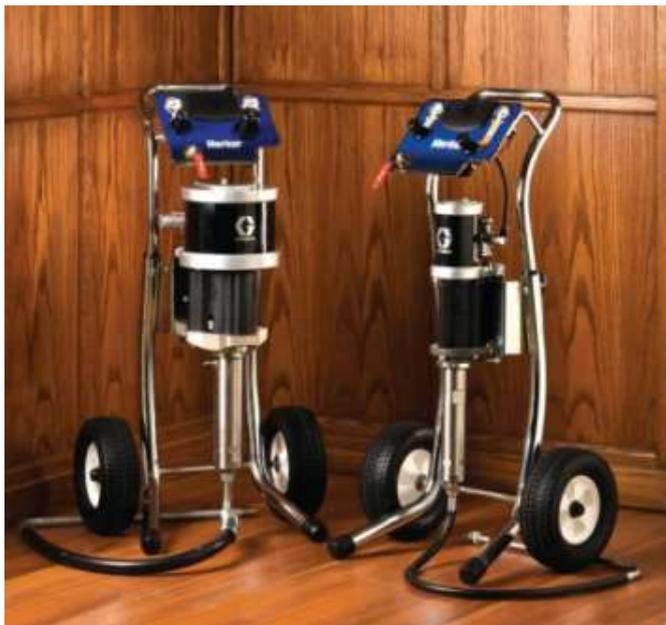
Насос Меркур 10:1, расход материала 4,5 л/мин (1,2 галл./мин), монтаж на тележке, пневмоклапаны насоса, шланг подачи воздуха, всас...
