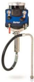
Комбинированная окрасочная установка Merkur 15:1, расход материала 1,5 л/мин (0,4 галл./мин), настенный, пистолет PerformAA 15, пн...
