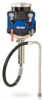
Насос Меркур 15:1, расход материала 1,5 л/мин (0,4 галл./мин), монтаж на тележке, пневмоклапаны насоса/краскораспылителя
