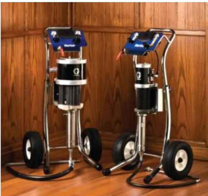
Насос Меркур 10:1, расход материала 4,5 л/мин (1,2 галл./мин), монтаж на тележке, пневмоклапаны насоса/краскораспылителя, всасываю...
