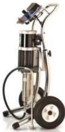
Установка безвоздушного распыления Merkur 24:1, расход материала 9 л/мин (2,4 галл./мин), монтаж на тележке, краскораспылитель XTR...
