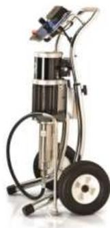
Установка безвоздушного распыления Merkur 23:1, расход материала 6 л/мин (1,6 галл./мин), монтаж на тележке, пистолет XTR-5, пневм...
