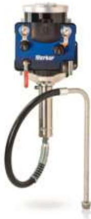
Установка безвоздушного распыления Merkur 23:1, расход материала 6 л/мин (1,6 галл./мин), настенная, пистолет XTR-5, пневмоклапаны...
