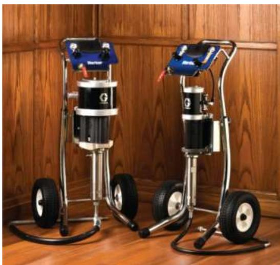
Насос Merkur 15:1, расход материала 3 л/мин (0,8 галл./мин), монтаж на тележке, пневмоклапаны насоса/краскораспылителя, всасывающи...
