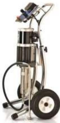
Насос Merkur 24:1, расход материала 9 л/мин (2,4 галл./мин), монтаж на тележке, пневмоклапаны насоса, всасывающий шланг, фильтр ЛК...
