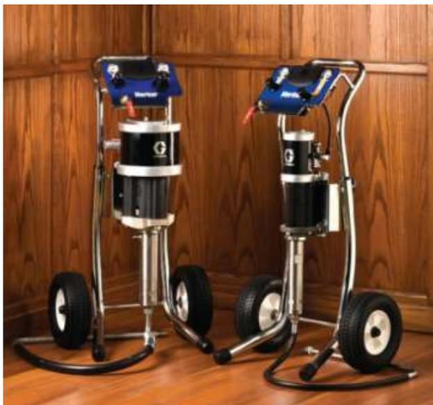
Насос Merkur 15:1, расход материала 3 л/мин (0,8 галл./мин), установка на стойке, пневмоклапаны насоса, шланги пистолета для возду...
