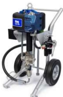
Распылитель King 50:1, без фильтра, легкая тележка, пневматическое управление, комплект сифона, XTR-5, шланг 15 м (50 футов), пово...
