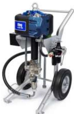
Распылитель King 45:1, встроенный фильтр, легкая тележка, пневматическое управление, комплект сифона, XTR-5, шланг 15 м (50 футов)...
