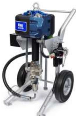
Распылитель King 30:1, встроенный фильтр, усиленная тележка, пневматические органы управления, комплект сифона
